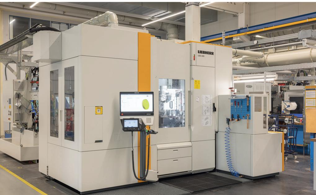
1 SPN profitiert beim Wälzstoßen auf der 'LS 180 E' unter anderem von den kurzen Rüstzeiten der Maschine; angesichts des breiten Teilespektrums ein elementarer Wettbewerbsvorteil © Liebherr-Verzahntechnik
